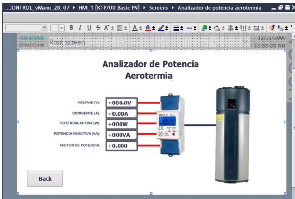
Figura 7.8: Analizador de potencia de la aerotermia.
